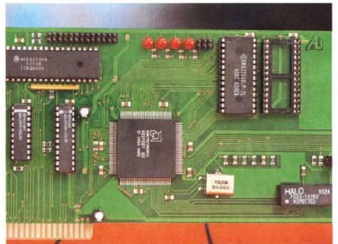
Il controller Ethernet montato dalla Ariadne è un AMD 79C960. Nella parte alta sono visibili i quattro LED di diagnostica, il connettore ausiliario per collegare dei LED montati esternamente, e il chip di RAM da 32 Kbyte utilizzato per il buffering.
